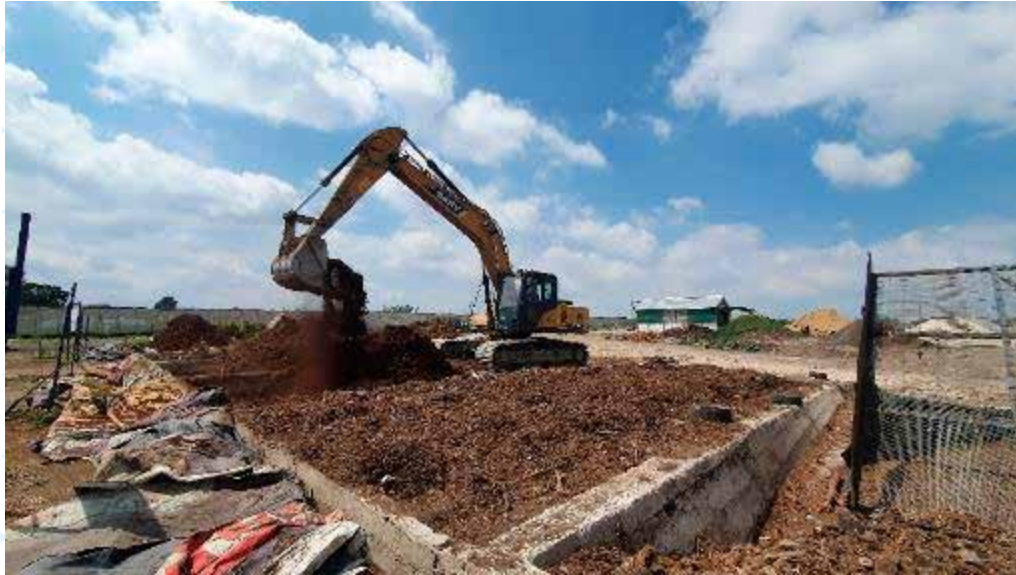
Figura 7 Volteo de material con excavadora en las pilas de compostaje.
